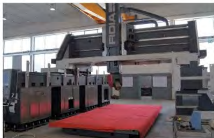
Una unità Fidia in costruzione evidenzia la sua struttura modulare, con basamenti dell'asse X rialzati e traversa longitudinale
