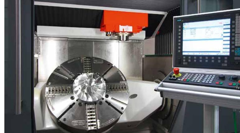
gensystemen, während der Senkrechtschlitten mit Kugellaufrädern mit vorgespannter Spindelmutter verfahren wird. Die Achsen werden durch digitale Antriebe mit Brushless-Servomotoren der jüngsten Generation gesteuert. Das alles garantiert eine außergewöhnliche Struktursteifigkeit und starke Dämpfung der Vibrationen.
