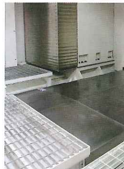
Weitere von P.E.I. gelieferte Technologien sind die Teleskop-Stahlabdeckungen auf der Y-Achse.
