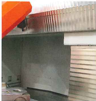
Emco setzt Abdecksysteme der P.E.I. ein: In der Mecof Umill 1800 sind zahlreiche Faltenbälge mit Stahllamellen verbaut.
