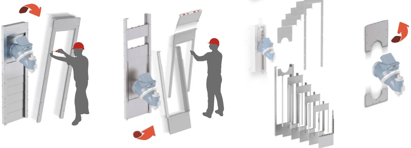
I pannelli che costituiscono la **Snap Telescopic Cover** possono essere smontati e rimontati in macchina senza dover rimuovere le teste della fresatrice, le torrette o i revolver multiutensili. Il telaio esterno di base resta fissato in macchina consentendo il rimontaggio dei pannelli senza dover eseguire allineamenti o calibrazioni.
