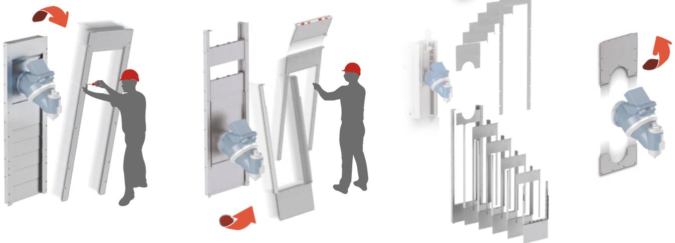
Los paneles que componen la **Snap Telescopic Cover** pueden ser retirados y re ensamblados sin necesidad de desmontar el cabezal de la fresadora, columna o multihusillos. El marco base exterior permanece fijo permitiendo remontar los paneles sin necesidad de calibración o alineamiento.
