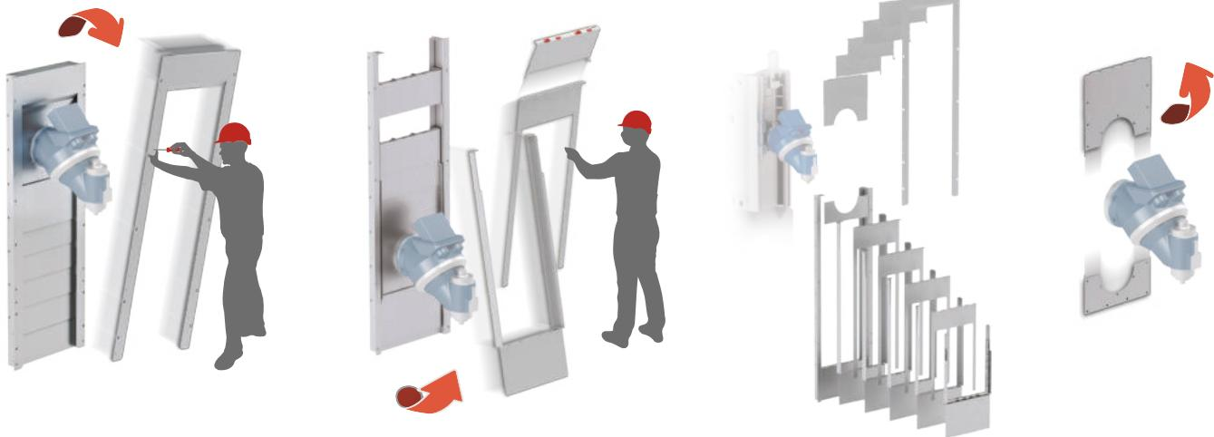
Die einzelnen Bleche, aus denen sich **Snap Telescopic Cover** zusammensetzt, können in der Maschine aus- und wieder eingebaut werden ohne den Maschinenkopf, den Ständer oder den Werkzeughalter ausbauen zu müssen. Der äußere Basisrahmen verbleibt an der Maschine damit die Bleche wieder eingebaut werden können, ohne die Abdeckung neu ausrichten oder kalibrieren zu müssen.
