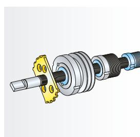
Il movimento rotatorio del tubo rispetto al perno centrale fisso viene ottenuto mediante un organo dentato scorrevole. Questo sistema consente di compensare l'allungamento delle molle multiple mediante uno spostamento assiale del fissaggio delle molle stesse utilizzando un perno filettato a più principi.
