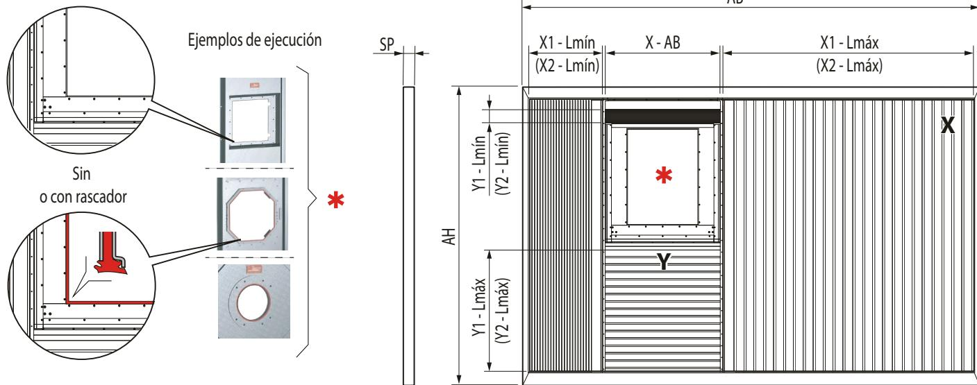
\* Hueco para el cabezal según diseño del cliente
