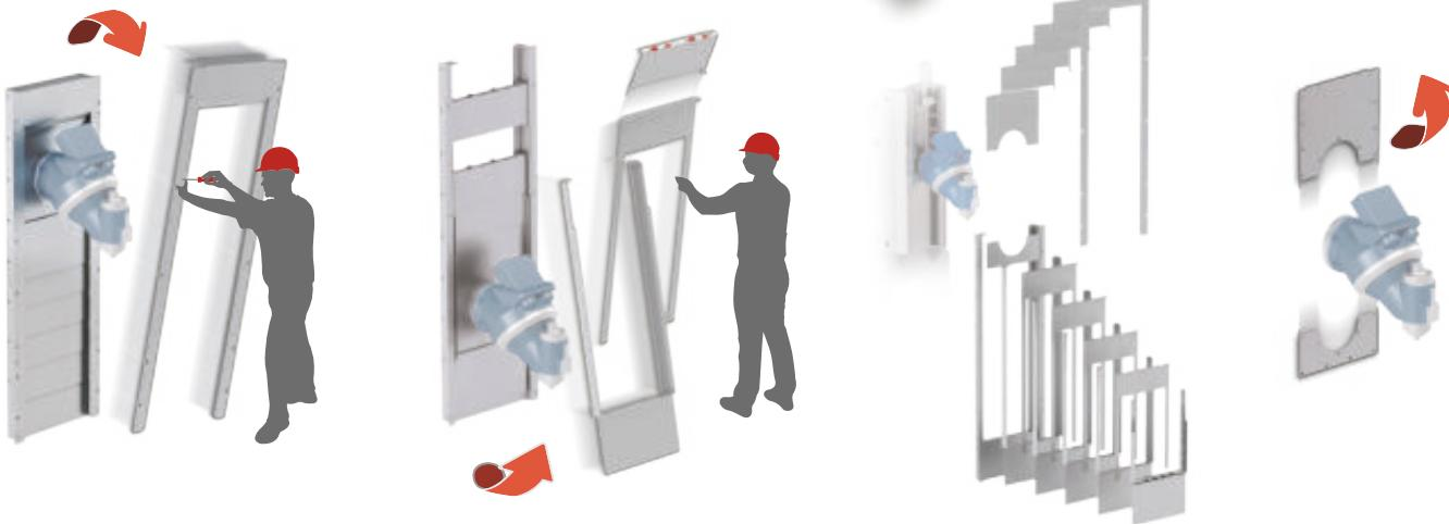
Панели **телескопического кожуха Snap** можно снимать и устанавливать без демонтажа рабочей головки станка. Рама кожуха крепится к машине, позволяя демонтировать панели без необходимости последующего выравнивания или калибровки.
