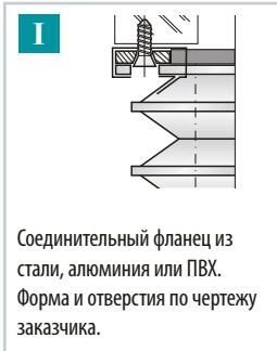
Соединительный фланец из стали, алюминия или ПВХ. Форма и отверстия по чертежу заказчика.
