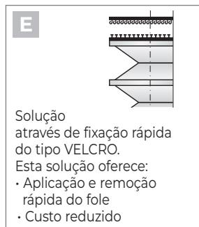
Solução através de fixação rápida do tipo VELCRO. Esta solução oferece:
