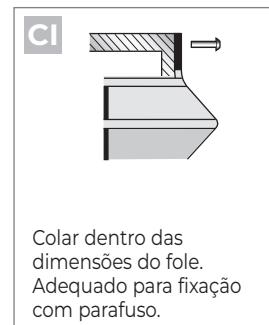
Colar dentro das dimensões do fole. Adequado para fixação com parafuso.
