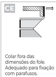
Colar fora das dimensões do fole. Adequado para fixação com parafuso.
