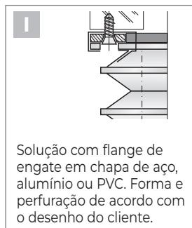
Solução com flange de engate em chapa de aço, alumínio ou PVC. Forma e perfuração de acordo com o desenho do cliente.
