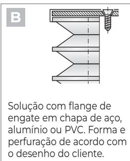
Solução com flange de engate em chapa de aço, alumínio ou PVC. Forma e perfuração de acordo com o desenho do cliente.
