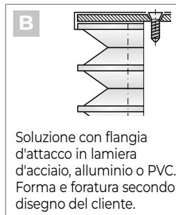
Soluzione con flangia d'attacco in lamiera d'acciaio, alluminio o PVC. Forma e foratura secondo disegno del cliente.
