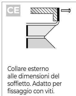
Collare esterno alle dimensioni del soffietto. Adatto per fissaggio con viti.
