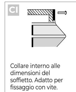
Collare interno alle dimensioni del soffietto. Adatto per fissaggio con vite.
