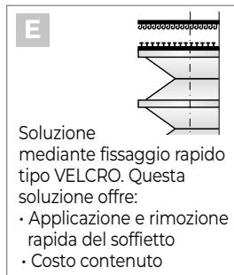
Soluzione mediante fissaggio rapido tipo VELCRO. Questa soluzione offre:
