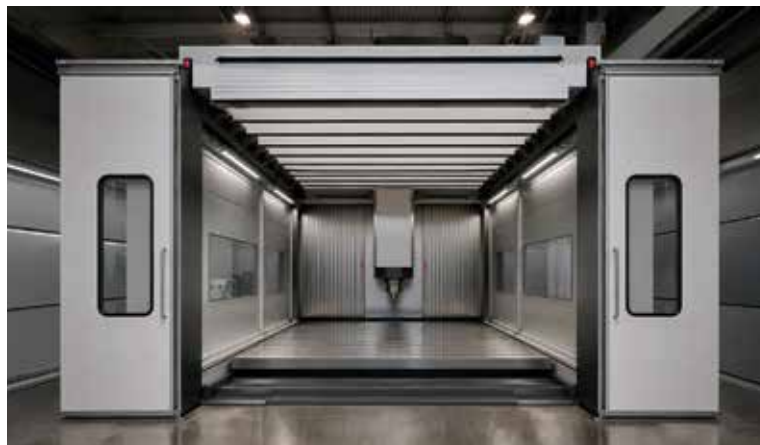
Esempio di macchina a traversa mobile accessoriata con il soffietto per cieli Wave Sky e la nuova motorizzazione E-SmartDrive.
